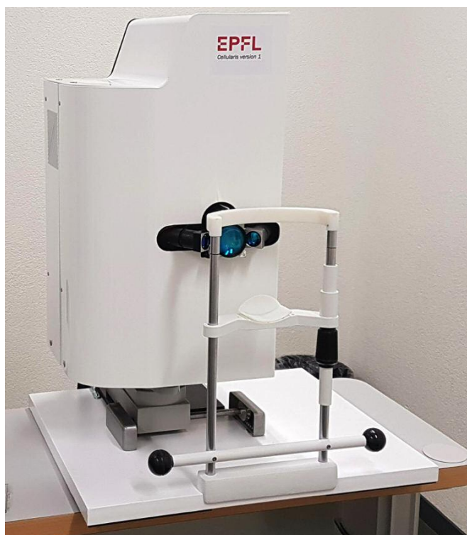
Рис. 1. Cellularis, прототип устройства для выявления дегенеративных офтальмологических заболеваний. Источник фото: LAPD
